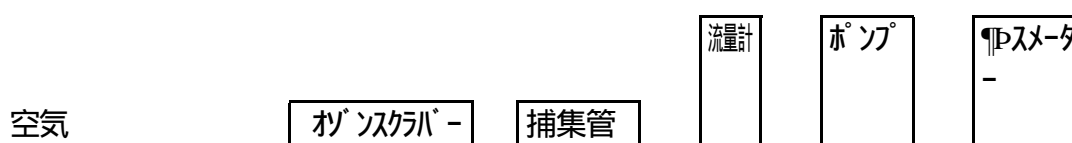
ホルムアルデヒドの試料採取装置の一例
